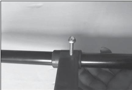
30. Retournez l'échelle en maintenant l'écrou et vissez à l'aide de la clef Allen (F) fournis et répétez l'opération pour chaque fixations.
