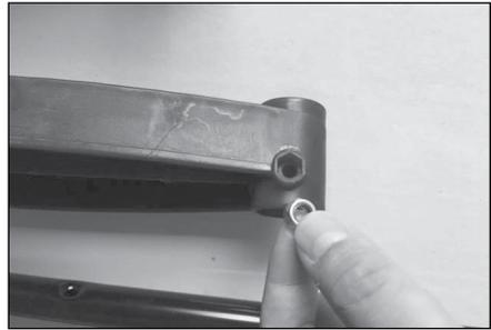
29. Insérez un écrou hexagonal (V) dans son emplacement.
