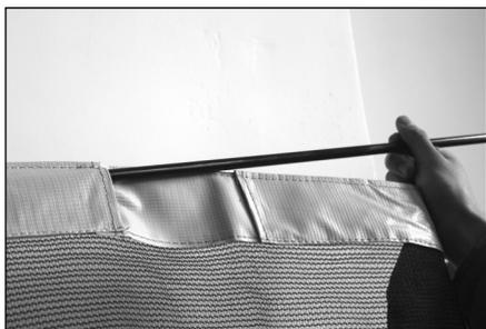
20. Insérez les tiges en fibre de verre (R) dans le filet de sécurité (S) de la manière suivante. Veillez à laisser les bouts dépasser aux interstices.
